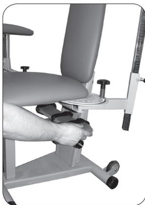
б) Для установки Устройства необходимо снять поддержку предплечья (21), открыв фиксатор (29) механизма переворота от храпового механизма. Во время установки Устройства необходимо следить, чтобы пружина, находящаяся внутри фиксатора, осталась в храповом механизме.
